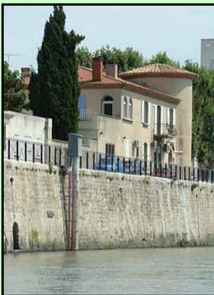
Limnigraphe et échelle visuelle sur le mur du quai de Trinquetaille, rive droite du Rhône, à Arles
